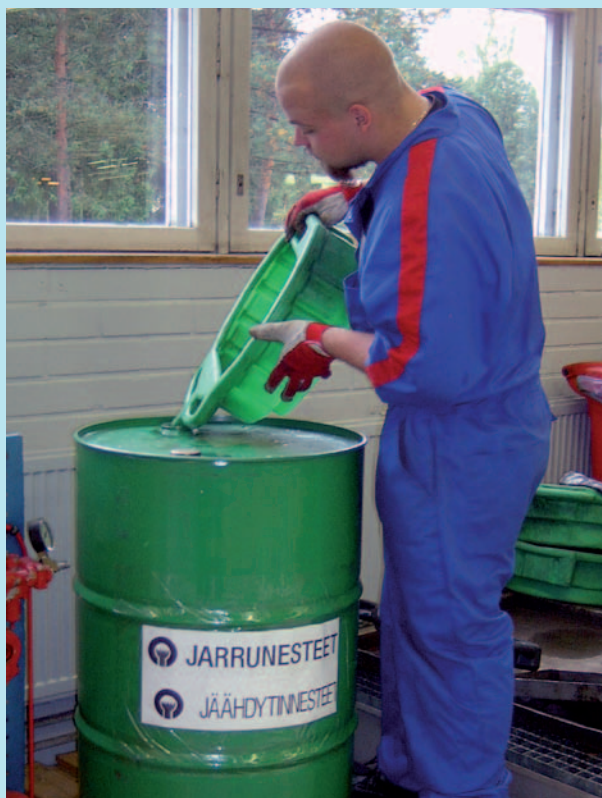
Kuva 2. Jos jäähdytinnesteitä ei toimiteta kierrätyskäsittelyyn, voidaan ne kerätä samaan astiaan jarrunesteiden kanssa.
