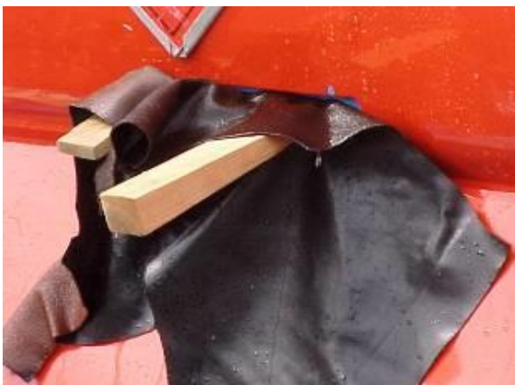
Kuva: vuoto tukittu kiilojen ja nahan avulla
